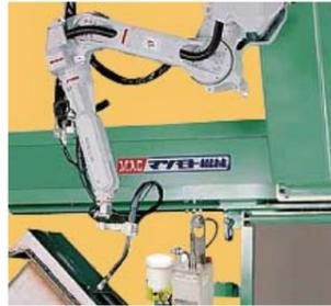
ロボメイトのRNP-3・RNP-7型は、アーク溶接用ロボットの溶接トーチのノズル内に付着したスパッタを除去し、スパッタ付着防止液を塗布することができます。RNP-5-VC型は、ワイヤの先端部をカットし常にワイヤつき出し長さを一定に保ちアークスタートを良くし、溶接を安定させることができます。これらを使用することによって、ロボットの連続稼働時間が大幅に延び、生産性と品質が向上します。
