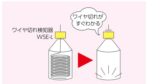
ワイヤ切れ検知器「WSE-L」は、パックワイヤのワイヤ切れを検知するための装置です。取付けは、パック用笠出口にねじ込むだけで簡単に行なえます。ワイヤ切れの信号はドライ接点信号となっており、警報ランプ・ブザー、ロボット等あらゆる運動に対応できます。
