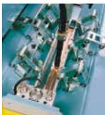
ステンレス材の薄板円筒物または楕円形状物の縦継ぎ直線溶接をプラズマ溶接法により自動で行なうものです。
